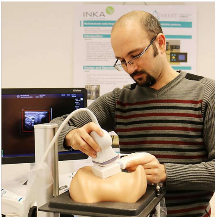
Doktorand Ali Pashazadeh testet sein System zur kombinierten Ultraschall- und Nukleardiagnostik bei einer Schilddrüsenuntersuchung am künstlichen Hals. (Foto: PRpetuum GmbH)
